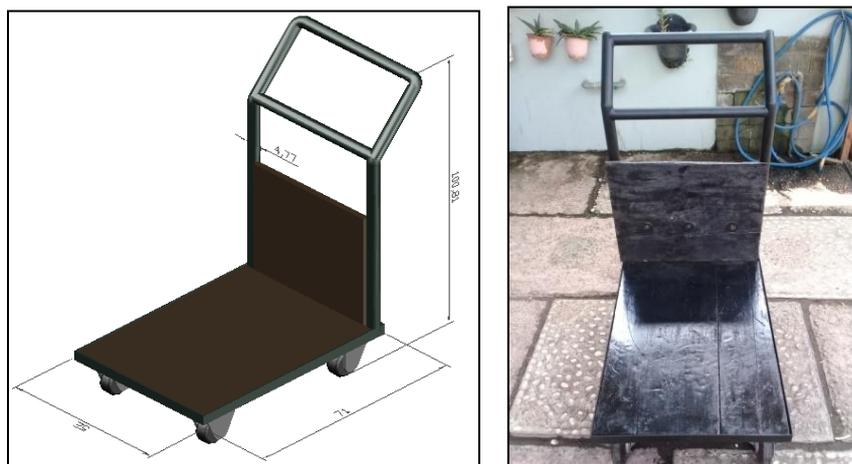
**Gambar 4.** *Design engineering* dan Produk troli ergonomi pengangkut bahan baku bata merah
