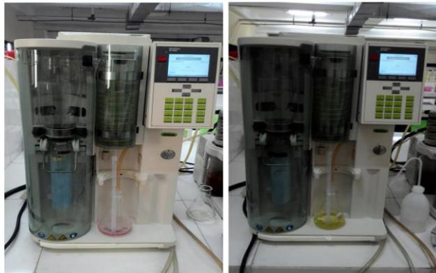
**Gambar 4.** Tahap Destilasi pada Pengujian Kadar Protein Menggunakan Alat Buchi Kjelflex K-360
