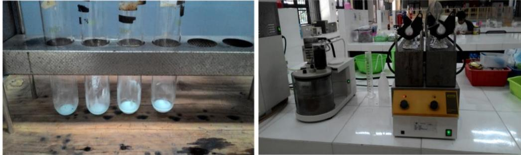
**Gambar 3.** Tahap Destruksi pada Pengujian Kadar Protein Menggunakan Alat Buchi Kjelflex K-360
