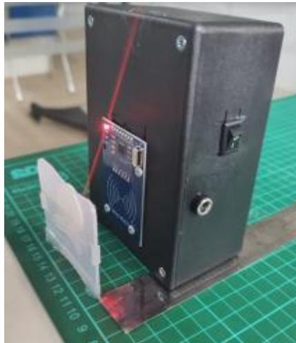
**Gambar11.** Proses pengujian jarak baca RFID *reader* terhadap RFID tag
