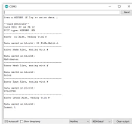
Gambar 5. Proses penulisan data memory RFID tag
