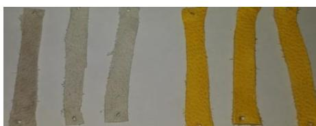
**Gambar 2.** Kulit setelah proses tanning (kiri) dan setelah proses retanning (kanan) Sebelum Pengujian
