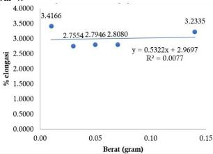
Gambar 4. Pemanjangan (elongasi) edible film variasi ekstrak lidah buaya
