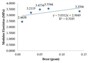
Gambar 5. Modulus elastisitas edible film variasi ekstrak lidah buaya
