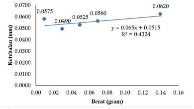
Gambar 2. Tingkat ketebalan edible film variasi ekstrak lidah buaya
