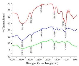
**Gambar 7.** (a) Spektra pati singkong (b) Spektra *edible film* tanpa ekstrak lidah buaya (c) Spektra *edible film* dengan variasi ekstrak lidah buaya
