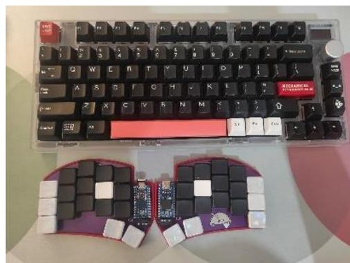
**Gambar 15** Perbandingan *Keyboard* 75% dengan *Ergonomic Keyboard*
