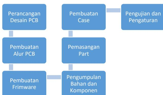
Gambar 1 Alur Pembuatan *Keyboard*
